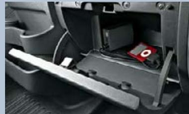
**Connexion Multimedia.** Situé dans la boîte à gants, le boîtier de connexion multimedia est composé de prises USB et aux-in. Il permet de connecter des sources audio aux haut-parleurs du véhicule. Les appareils connectés peuvent être commandés via l'interface de la radio.
