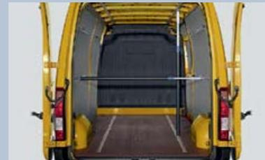
**Barres télescopiques de blocage (x 2).** Ces barres sont installées horizontalement et/ou verticalement sur des rails de fixation, permettant ainsi un arrimage des charges lourdes sans risque et en toute sécurité.
