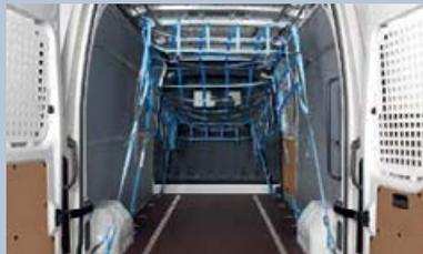
**Filet de chargement au toit.** Ce filet de chargement tri-dimensionnel, flexible et adaptable, est idéal pour les charges de dimensions différentes.
