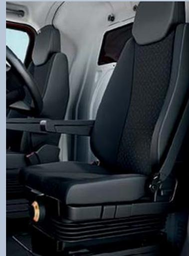
**Siège conducteur à suspension pneumatique.** Disponible en option et parfaitement adapté à une conduite sur routes difficiles ou sur de longues distances, il dispose de quatre réglages et d'un accoudoir fixe. La sensibilité de la suspension est également ajustable.
