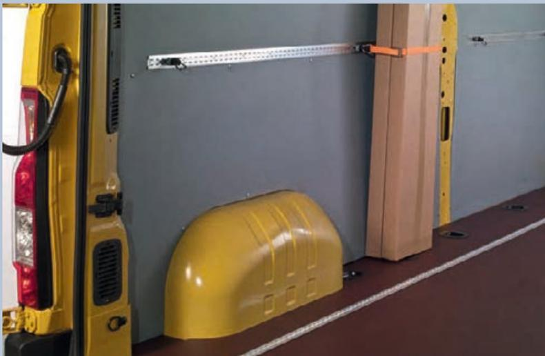
**Sangles d'arrimage (x 2).** Sangles pour sécurisation des charges sur les rails latéraux, garantissant un espace de chargement sécurisé.
