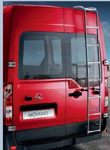
**Échelle arrière.** En acier robuste, elle simplifie l'accès au toit. Elle est conçue pour convenir en hauteur aux Movano H1 et H2.
