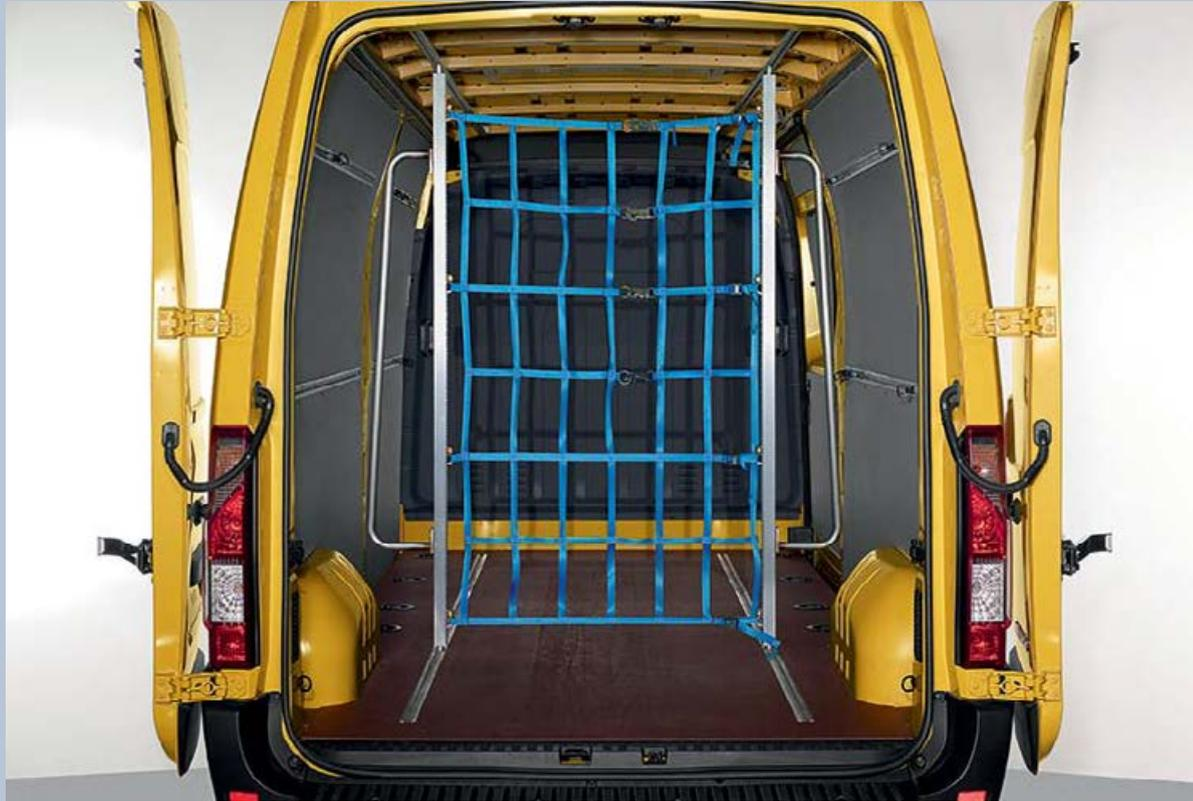
**Séparation mobile pour fractionner l'espace de chargement.** Accrochée au toit et au plancher par des rails de fixation, cette option est particulièrement utile pour retenir tous types de charges. Cette séparation propose également une ouverture mi-hauteur permettant l'accès de part et d'autre de l'espace de chargement.
