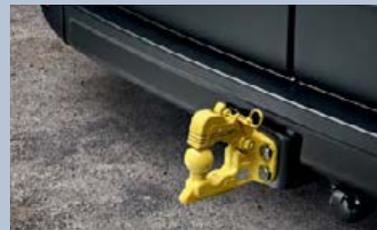
**Crochet d'attelage mixte.** Ce dispositif de remorquage de qualité et solide, accentue la facilité d'utilisation et la polyvalence de l'Opel Movano. Il comprend un adaptateur électrique à 7 ou 13 broches. Les composants électriques doivent être commandés séparément.
