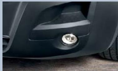
**Projecteurs antibrouillard avant.** Encastrés pour éviter toute détérioration en cas d'accident et positionnés à un emplacement optimal.
