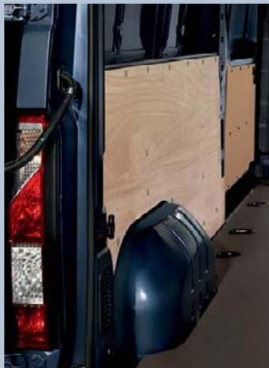
**Protections bois.** Hauteur totale ou mi-hauteur, ces protections bois protègent les panneaux. Un plancher bois disponible en option permet également de protéger le sol de la zone de chargement.
