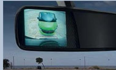
**Caméra arrière.** La caméra de recul guide le conducteur en lui donnant une vision parfaite de l'arrière du véhicule. La rétro-vision se fait soit sur un écran LCD 3,5 pouces intégré directement sur le rétroviseur intérieur, soit sur l'écran 7 pouces de la navigation.
